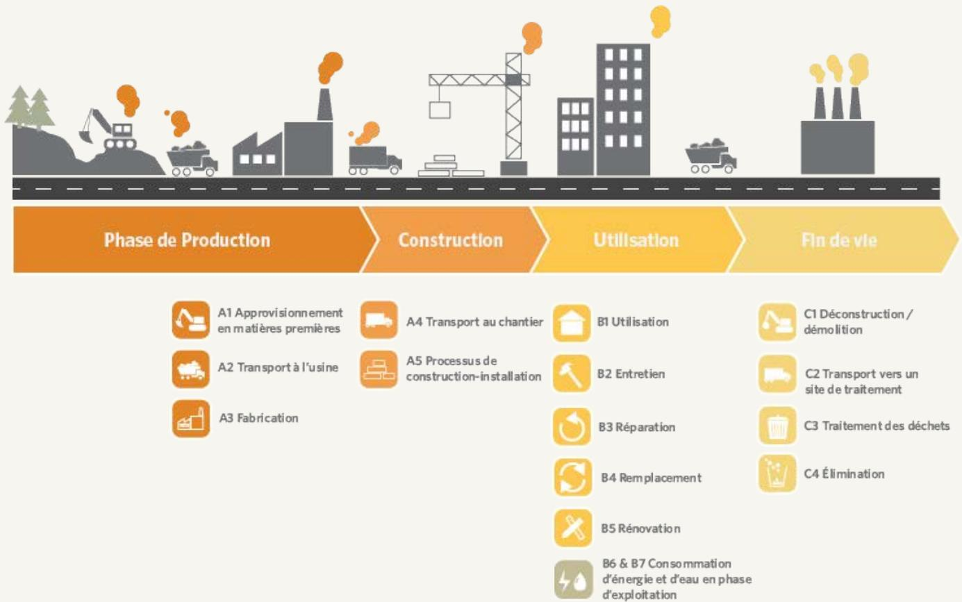
Figure 1: Carbone intrinsèque et Carbone opérationnel au cours des différentes phases du cycle de vie d'un bâtiment.<sup>15</sup>
